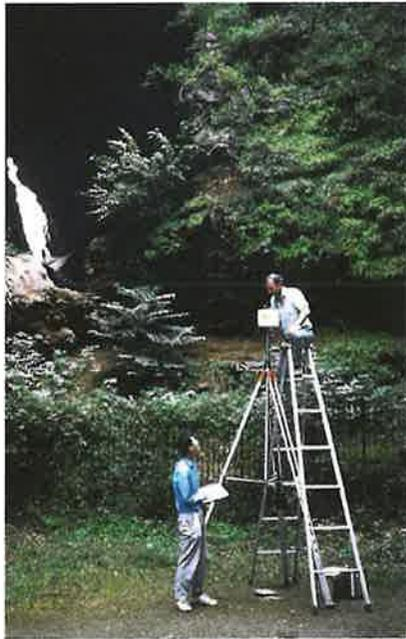
Exemple d'une mesure de gradient vertical avec 1 point au sol et 1 point à 3 mètres de hauteur. Le point au sol est mesuré 4 fois et le point en hauteur 3 fois.
