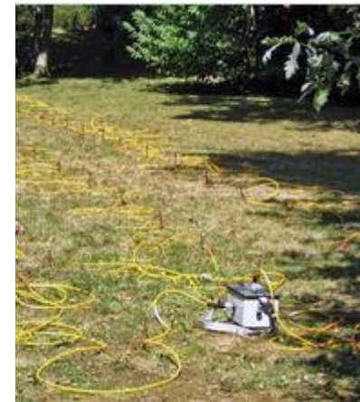
Flûtes multiélectrodes en place sur le terrain
