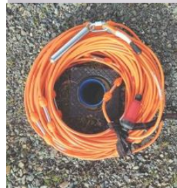
Exemple de matériel employé pour effectuer de la Tomographie de Résistivité Electrique
