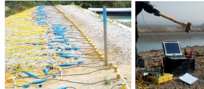
Figure 6 : A gauche, dispositif avec 96 géophones V / A droite enregistreur DaqLink, PC et batterie
