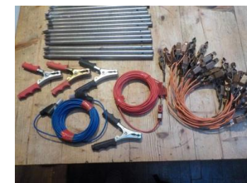
Exemple de matériel employé pour effectuer de la Tomographie de Résistivité Electrique
