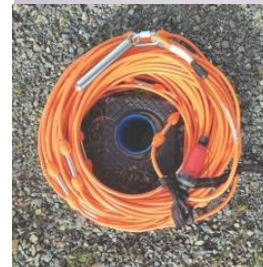
Exemple de matériel employé pour effectuer de la Tomographie de Résistivité Electrique
