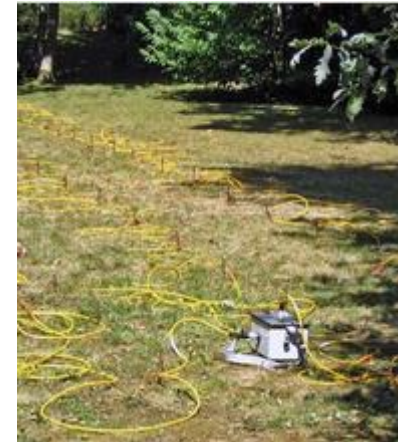
Flûtes multiélectrodes en place sur le terrain
