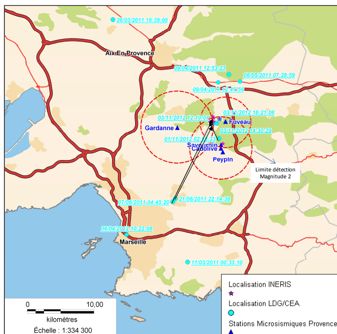
Figure 5 : position des événements détectés par le CEA/LDG (ronds bleu) situés dans un rayon de l'ordre de 30 km autour des réseaux de surveillance de Provence. Les pointes de flèches indiquent la localisation INERIS des mêmes événements à partir des signaux enregistrés par les réseaux de surveillance microsismique de Provence. Les cercles en rouge pointillé indiquent les limites de détection d'un événement de magnitude 2 par les stations microsismiques.
