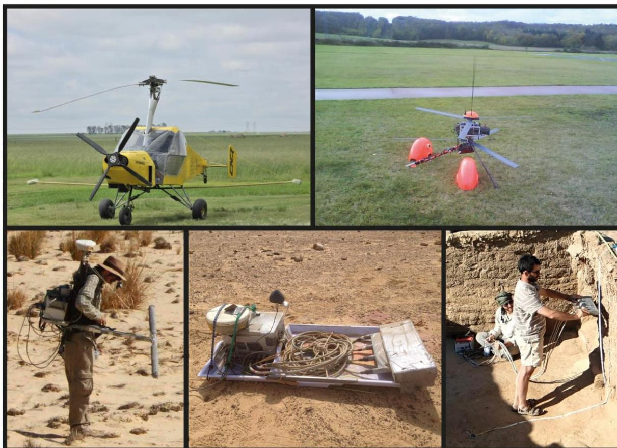
Figure 1 – Exemple de dispositifs mis en place à l'EOST. De gauche à droite et de haut en bas : prospection aérienne en collaboration avec Gyrolag ; Drone en collaboration avec ECA Robotics ; dispositif porté (résolution demi-métrique) ; dispositif traîné (résolution centimétrique) ; dispositif pour mesure verticale.
