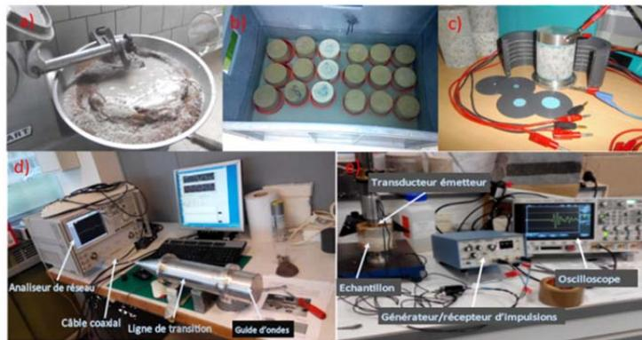
**Figure 2 :** a) Outil de malaxage utilisé pour la constitution des échantillons présentés à la figure b) (crédits : Cerema). c) cellule de résistivité électrique (crédit: Ifsttar) d) cellule électromagnétique (crédit: Ifsttar) e) cellule acoustique (crédit: Ifsttar).
