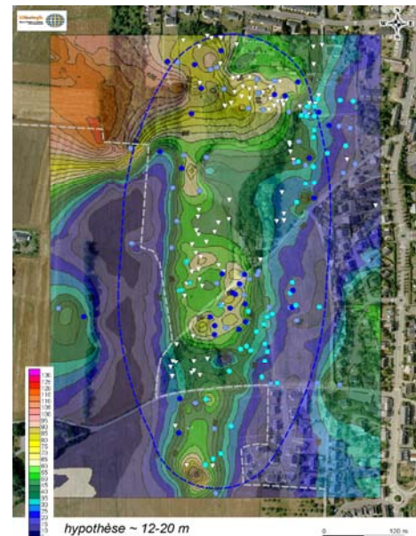
Exemple de coupe de panneaux après inversion (modèle de résistivités vraies) et de carte d'iso-valeurs de résistivités apparentes (de 12 à 20 m de profondeur).
