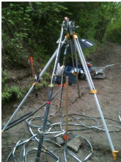
**Figure n°01: Mise en place de l'antenne radar de forage dans un des équipements**
