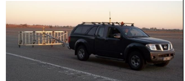
Exemple des différents types de dispositifs fluxgate : 4 sondes VALLON géoréférencées (en haut à gauche), monosonde Foerster (en haut à droite), dispositif 8 sondes géoréférencées EBINGER/SENSYS tractées par un véhicule (en bas)
