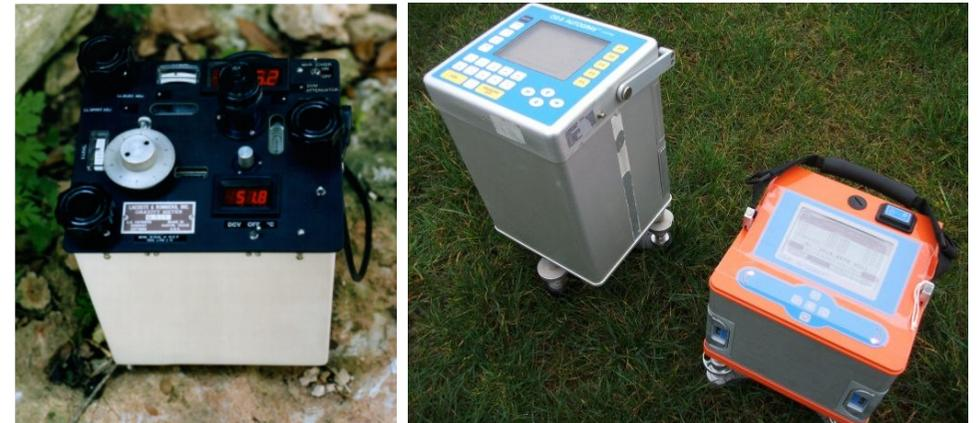
Gravimètre Lacoste & Romberg (à gauche) et gravimètres Scintrex CG5 et CG6 (à droite)
